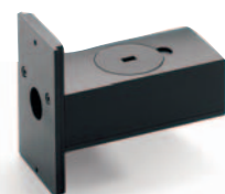
15°, 20°, 30°, 45°, and 60° Specular Reflectance Accessories
